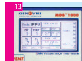
13 MOG 1000 Sürekli akı , neonatal acil respiratör, Ventilasyon Modları; CPAP, IPPV, SIMV tetikleme ile
